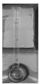
Нами разработана, многократно испытана и рекомендована к применению методика проверки эффективности действия гидрофобизатора с помощью трубки Карстена (на фото слева).
